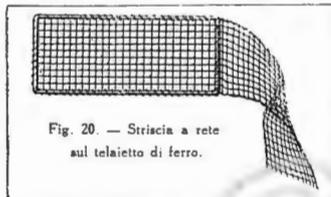
Fig. 20. — Striscia a rete sul telaio di ferro.
